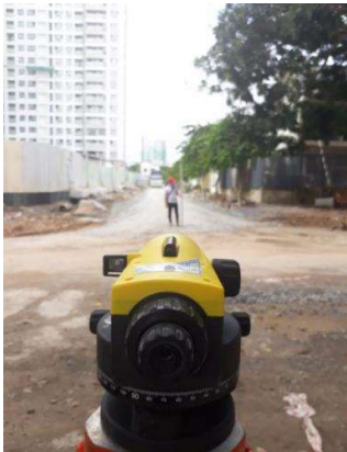
Hình 5-5 Kiểm tra cao độ bằng Máy thủy bình
